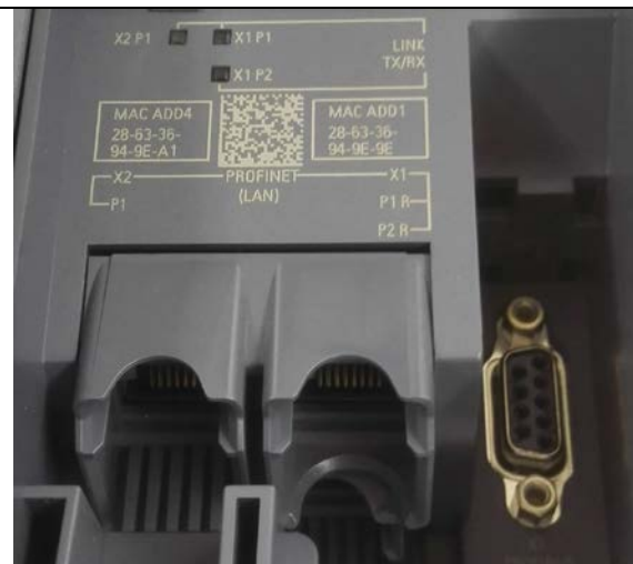
Abb. 2: Schnittstellen: X3 MPI/DP X1 PN Port1, Port2
