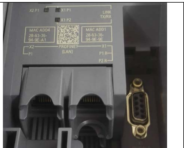
Abb. 2: Schnittstellen: X3 MPI/DP X1 PN Port1, Port2
