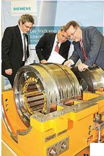
Siemens investiert einen siebenstelligen Betrag in die Versuchsanlage, in der die Magnetlager unter simulierten Kraftwerksbedingungen erprobt und untersucht werden. | Matthias Weber
