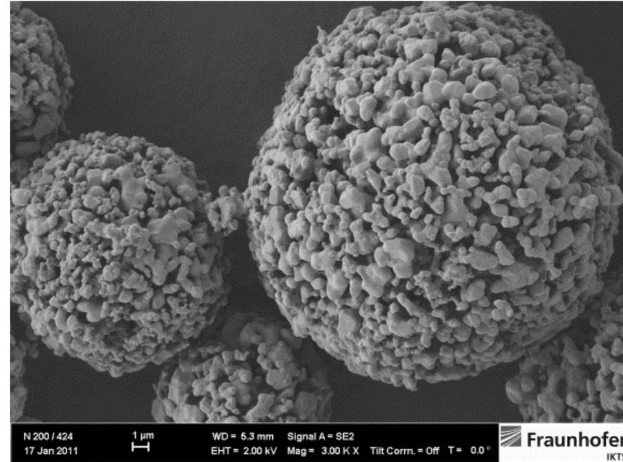
Komplexe Partikel für Lithium-Batterie-Elektroden
