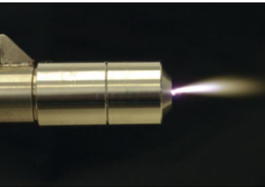
Bei dem Mikrowellenskalpell fließt Gas durch eine Kanüle, das unter Zuführung von Mikrowellenenergie erhitzt wird. An der Spitze des Skalpells tritt das Gas als gebündelter Plasmastrahl aus, der bis zu 3 400 Grad Celsius heiß wird.
