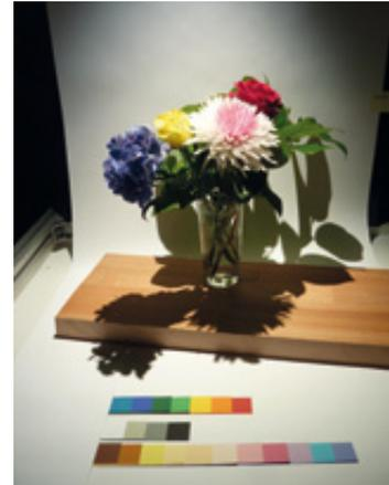
Sollektoren liefern dank der direkten Weiterleitung von Sonnenlicht ein natürliches und flimmerfreies Lichtspektrum. Auf Wunsch können hohe Kontraste erzeugt werden, was eine flexible Lichtgestaltung ermöglicht (Foto links; rechts: LED-Beleuchtung).
