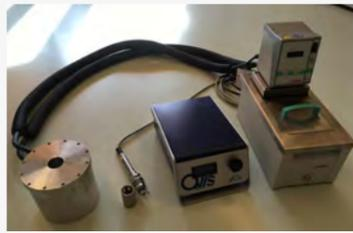
Viskositäts-Messsystem mit Temperiergefäß, Messsonde, Datenlogger und Badthermostat (v.l.)
