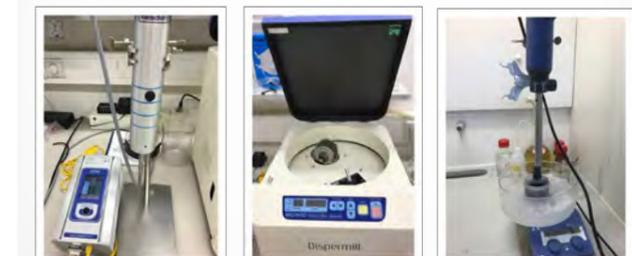
Ultraschallgerät UP200ST Centrifugal Planetary Mixer Ultra Turax
