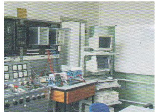
Bild 107: Digitale Schutz- und Prüftechnik am Versuchsstand Distanzrelais“
