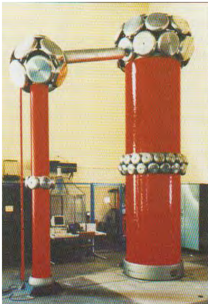
Bild 55: Salznebelkammern und zugehörige Messtechnik hinter der 1980 aufgestellten Wechselspannungsprüfanlage 700 kV/350 kVA
