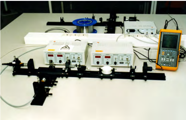
Bild 115: Versuchsanordnung „Faseroptischer Verstärker“ mit Erbium dotiertem Lichtwellenleiter
