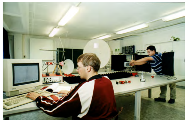
Bild 110: Messung der Strahlungscharakteristik von Richtantennen am Antennenversuchsstand
