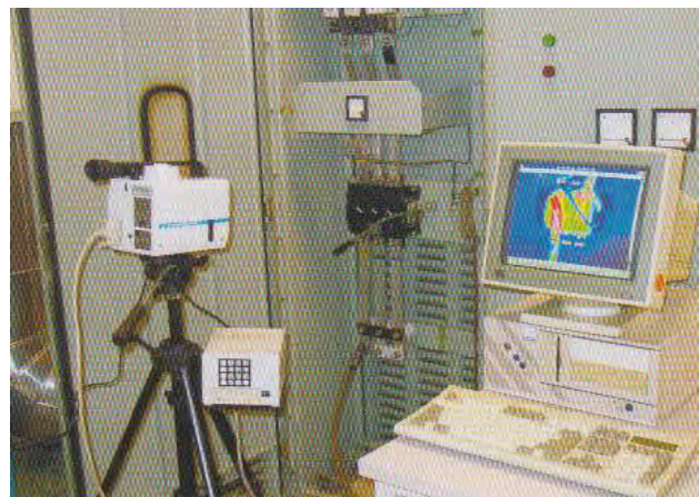
Bild 103: Thermografiesystem an einem Praktikumsversuchsstand zur Lehrveranstaltung Technische Diagnostik
