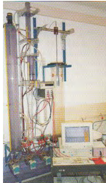
Bild 86: Versuchsstand „Hydrostatische Füllstandsmessung“ und „Gasgehaltsmessung“
