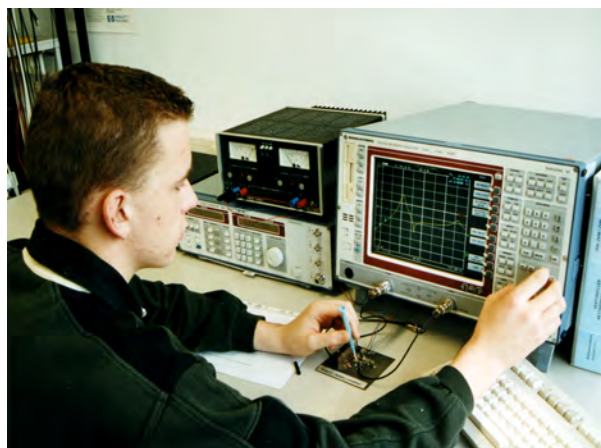
Bild 114: Abgleich einer HF-Baugruppe mit dem Netzwerkanalysator
