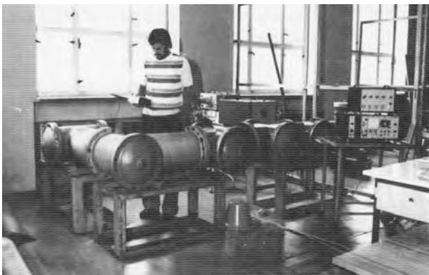
Bild 48: Aufbauten zur akustischen TE-Diagnostik an SF 6 -Anlagen
