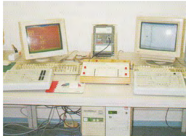
Bild 65: Elektronisches Prozessmodell Bunkerbeschickungsanlage von einer SPS Schiele S104 gesteuert (davor 2 weitere Prozessmodelle; links Hochspannungsschaltfeld, rechts Mischanlage)
