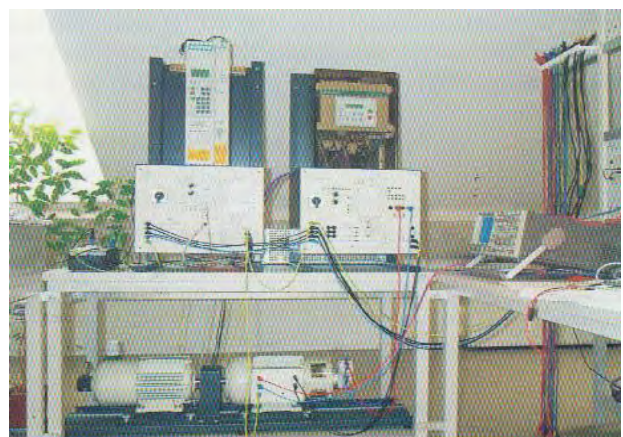
Bild 97: Versuchplatz zur Untersuchung elektrischer Antriebe
