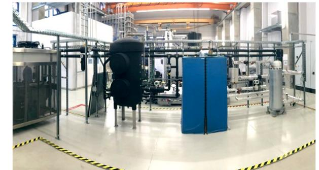
Projektschwerpunkt ist es folglich, mit Hilfe von Versuchsanlagen das Verhalten von Einzelkomponenten (Trockner, Vergaser, BHKW, sensibler Wärmespeicher, Latentwärme- und Latentkältespeicher) im System und das Systemverhalten inklusive der Quer- und Rückkopplungen zu untersuchen und zu analysieren.
