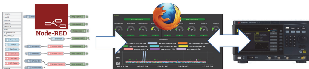
Abb. 4: Funktionsprinzip zur Erstellung von Web-Anwendungen mit Hilfe grafischer Blöcke innerhalb von Node-Red.
